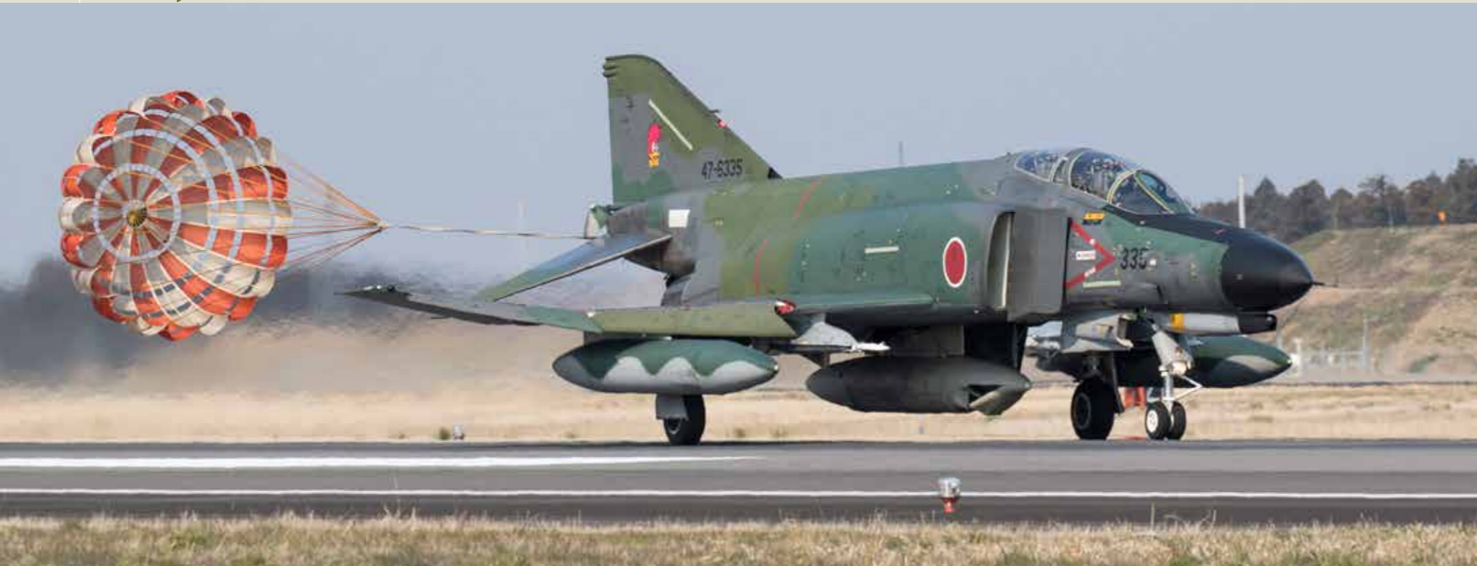
Die RF4-EJ Kai Phantom II gehört zum Teisatsu Kokutai (=Luftaufklärungsgruppe) des 501. Hikotai. Bei der Maschine mit der Kennung 77-6392, welche die Aufklärungsbehälter am Rumpf trägt, handelt es sich um einen der 17 zum Aufklärer modifizierten Abfangjäger.
